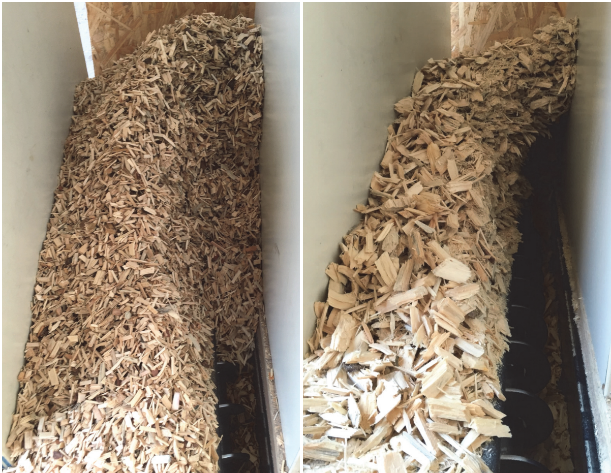
Abbildung 6: Halbmanuelle Brennstoffaufgabe (schwerkraftunterstützt) für Holzhack- schnitzel B1 (P16S, WG13%) (links) und B4b (P31S, WG20,1%, FG15%) mit temporär auftretender Brückenbildung über der Förderschnecke (recht)
