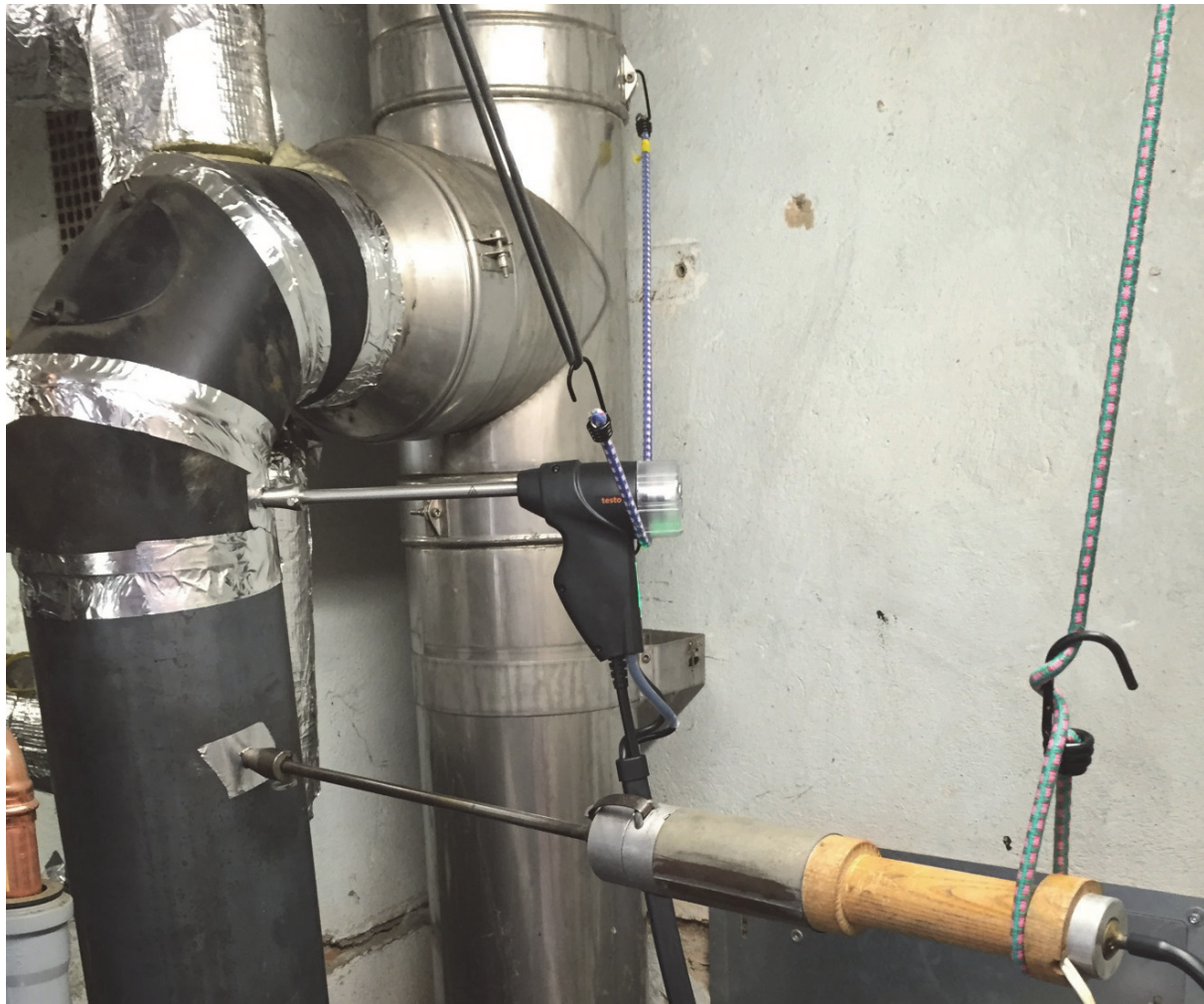
Abbildung 10: Probenahmestellen für Staub (Wöhler) und Testo (Staub, O 2 , CO 2 und CO)
