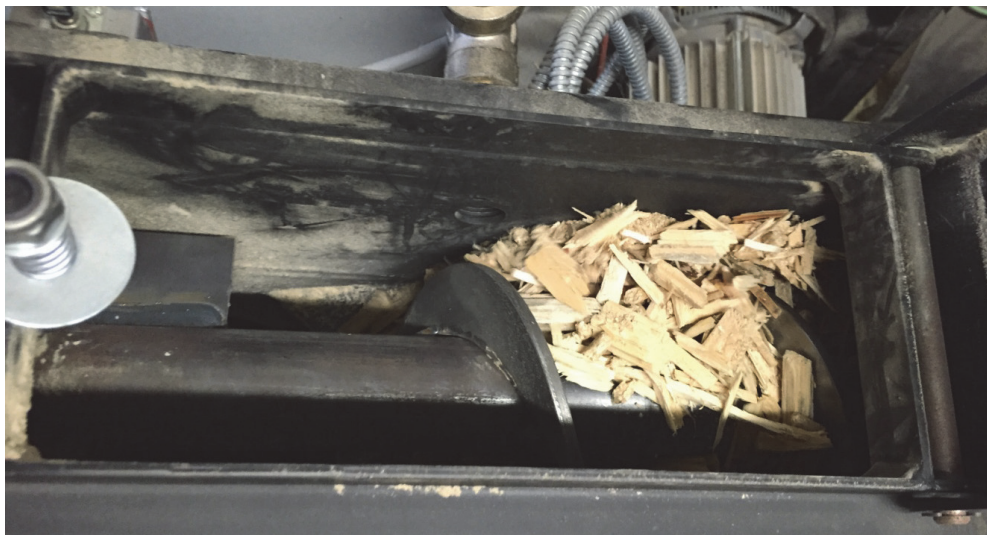
Abbildung 5: Förderschnecke – Detailansicht bei geöffneter Wartungsklappe
