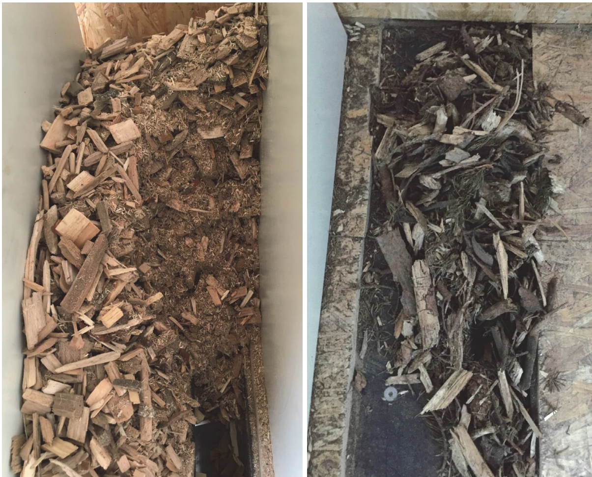
Abbildung 7: Links: Entmischung des Brennstoffes durch hohen Feingutanteil (B6a, P45S, WG27,1%, FG10%) Rechts: Aufgabe von Brennstoff B7 (P45, WG20,6%, WRH)
