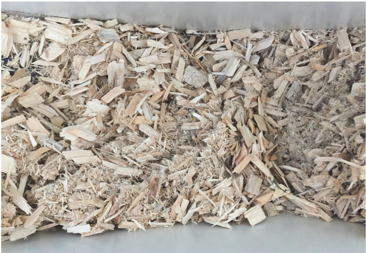
Abbildung 1: Brennstoff mit zugemischtem Feinanteil (B 4a , P 31S WG 17,7% FG 10% ) in der Brennstoffzuführung für die 75 kW-Anlage
