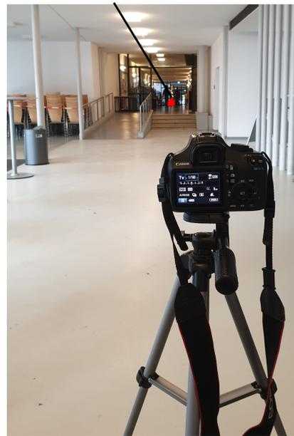
Abbildung 2: Aufbau zur Bestimmung der Projektionsfläche. Im Hintergrund ist das zu fotografierende Velomobil zu sehen. Die Kamera befindet sich ca. 36 m vor dem Fahrzeug.
