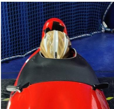
Abbildung 9: Als Kopfersatz wurde ein abgeklebter Fahrradhelm genutzt.
