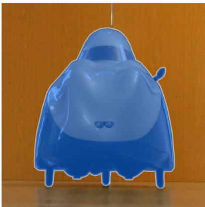
Abbildung 1: Flächenbestimmung im CAD-Programm. Die vermessene Kontur ist blau dargestellt.
