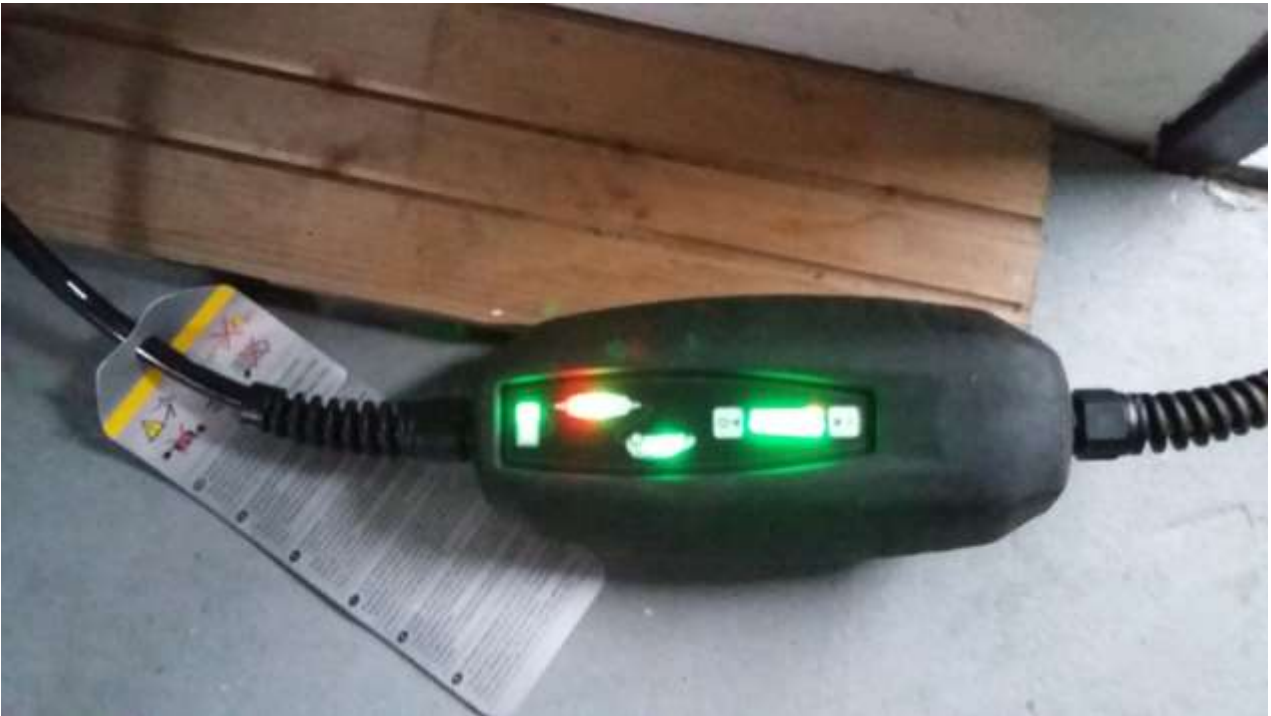
Abbildung 15: Schuko-Ladekabel mit „Steuergerät“ des Projekt-Autos
